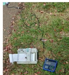
振動測定の様子 産総研付近の道路で振動測定の実習を行いました。
