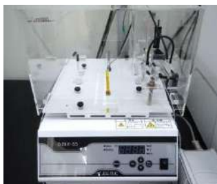
蒸留加熱槽、主に蒸留を担当
